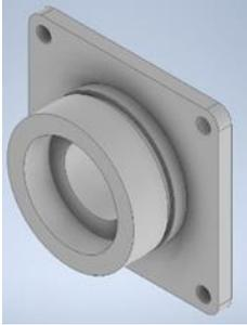
Abbildung 56: RW-Lagerdeckel (mit Bohrung) (eigene Darstellung)
